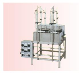
EU型フッ素イオン水 蒸気蒸留装置用マントルヒーター
